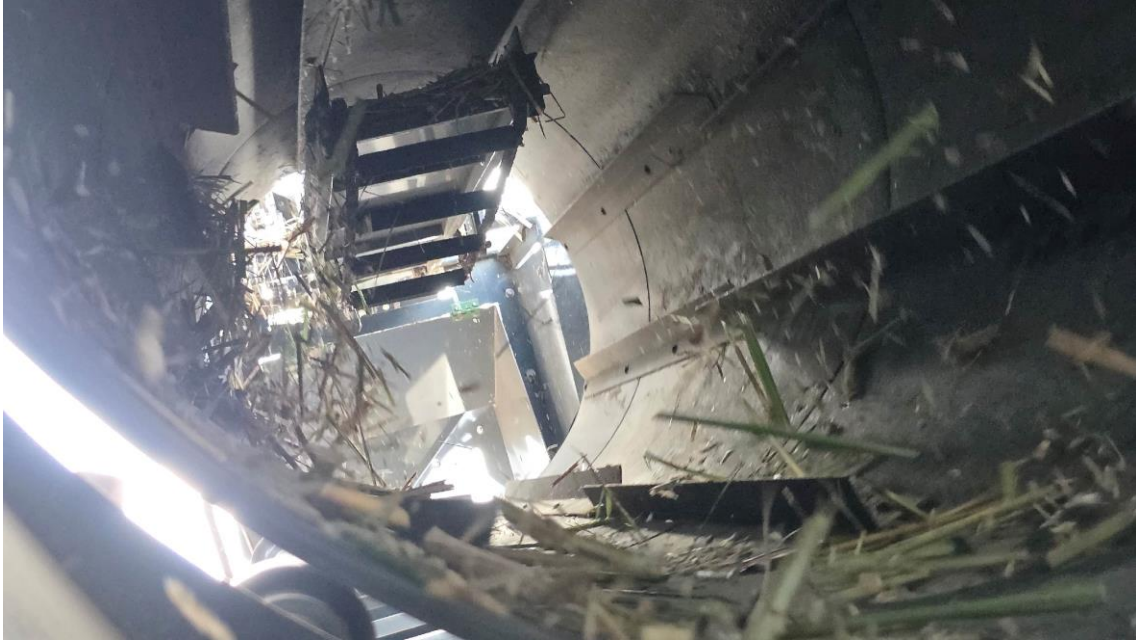
Figura 6: interior del cilindro donde cae el material molible y es separado de las hojas
