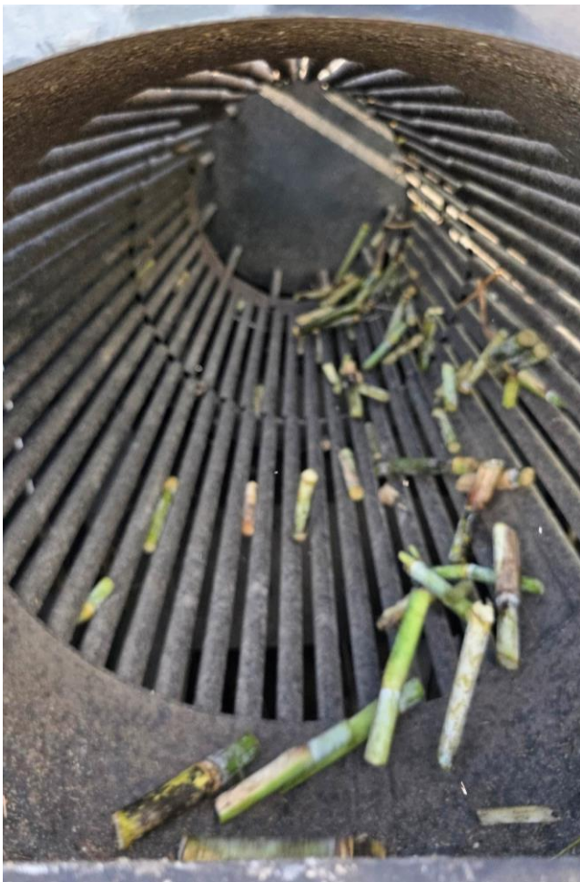
Figura 15: cilindro estriado con ranuras para separar la parte molible del trash
