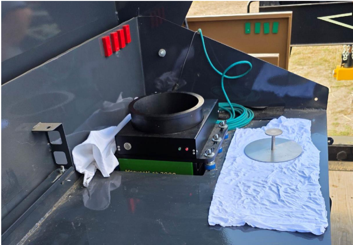
Figura 20: NIR incorporado en el tráiler
