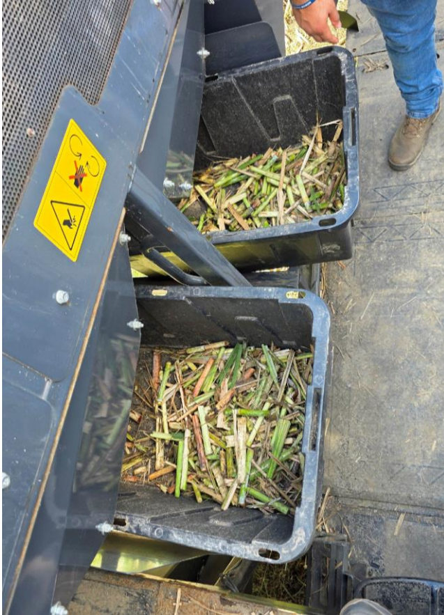
Figura 16: bandejas en donde se va recolectando el despunte y las hojas
