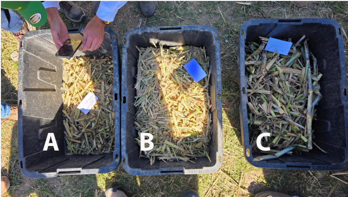
Figura 11: resultados de la experiencia. A: extractor a 750 rpm. B: Extractor a 930 rpm. C: muestra tomada en la actividad 1 de parcelas a campo.
