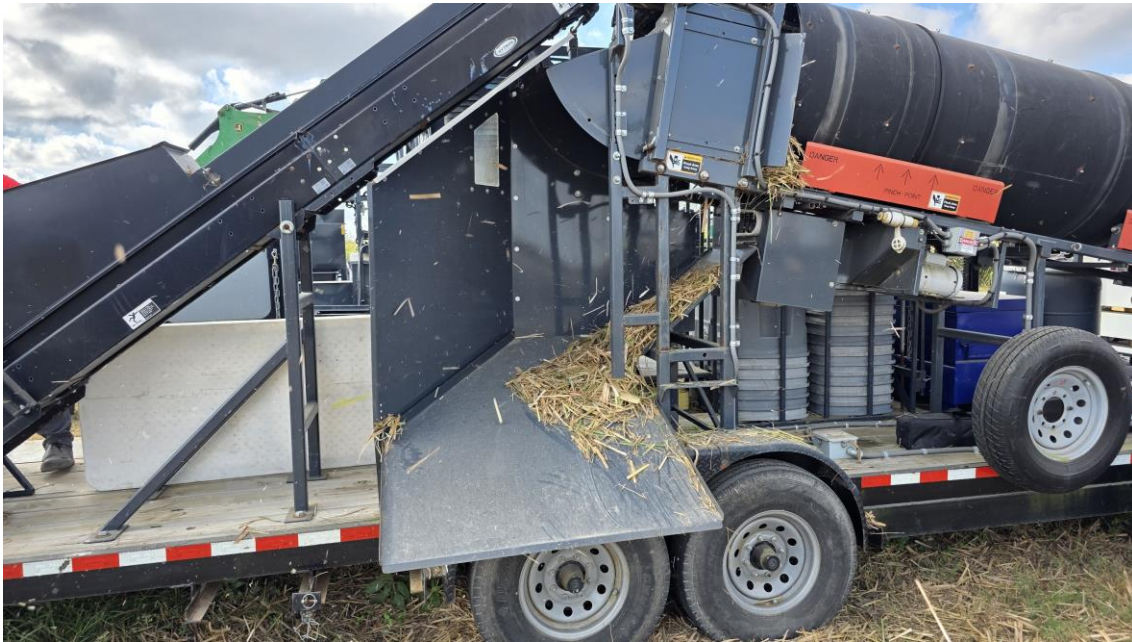
Figura 8: salida de las hojas secas por adelante del cilindro
