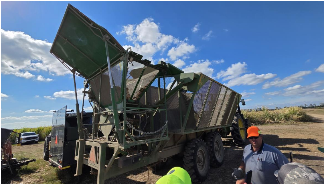
Figura 12: autovuelco con tolva para extraer muestras de cosecha
